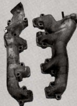
Ford Cobra Jet exhaust manifolds #'s C8OZ-9430-A (R), C8OZ-9431-A (L).
